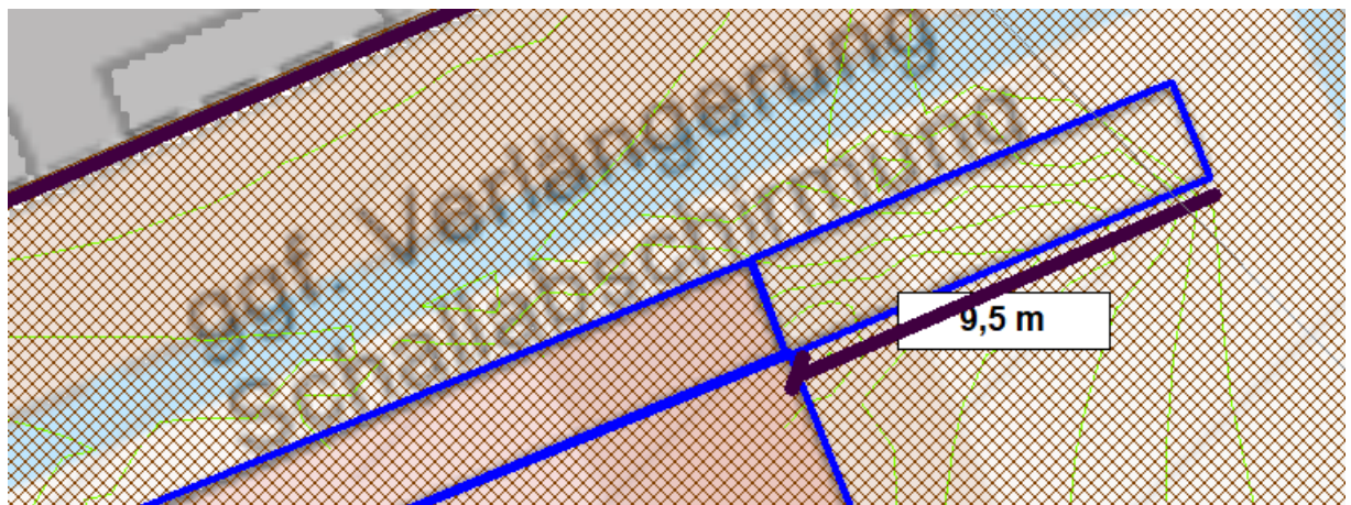
Bild 2 Verlängerung der Schallschutzwand l= 9,5 m (abs. Höhe 389,06 m)
