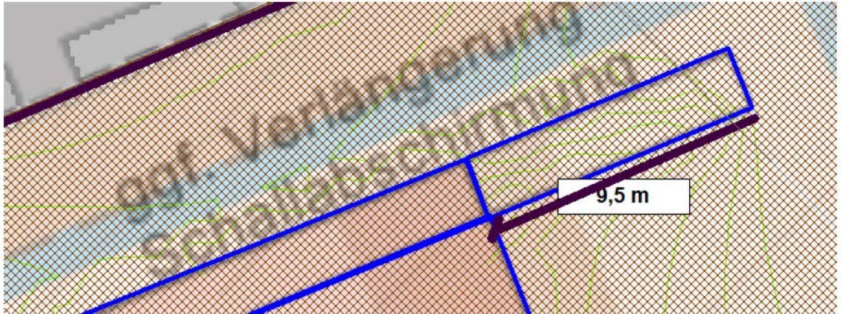
Bild 2 Verlängerung der Schallabschirmung l = 9,5 m (abs. Höhe 389,06 m)
