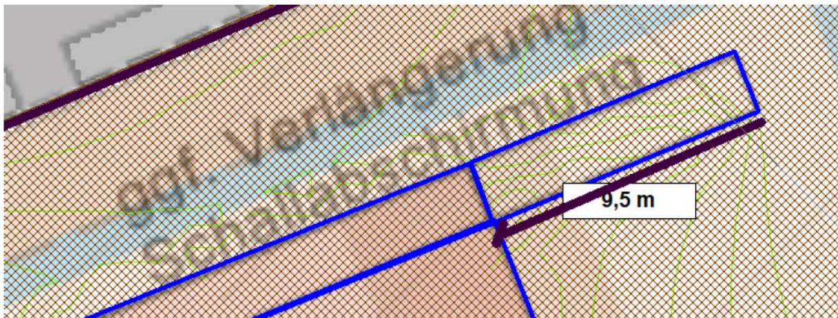
Bild 2 Verlängerung der Schallabschirmung l = 9,5 m (abs. Höhe 389,06 m)
