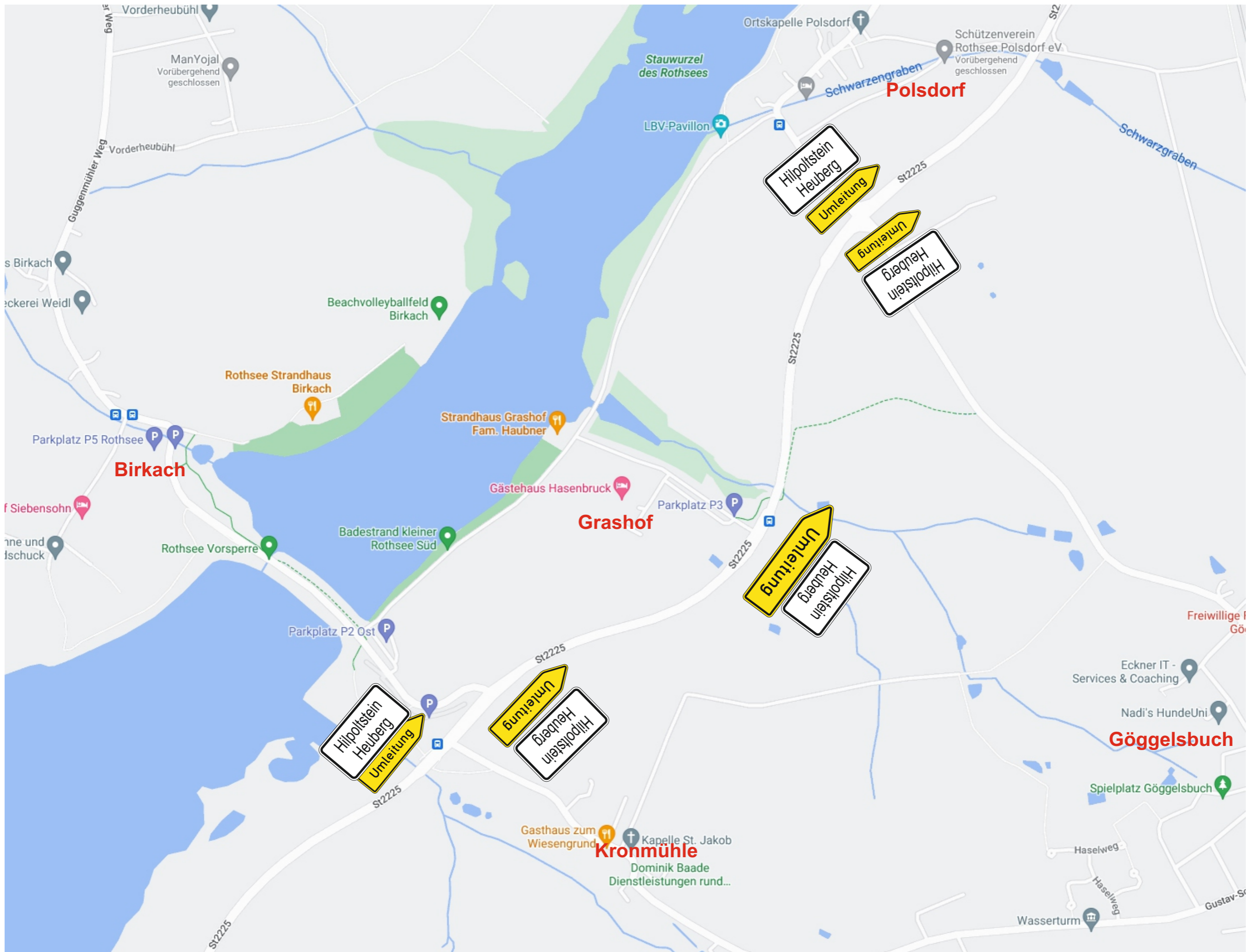
Vor- / Wegweisungen „Hilpoltstein“ an allen Einmündungen abdecken
