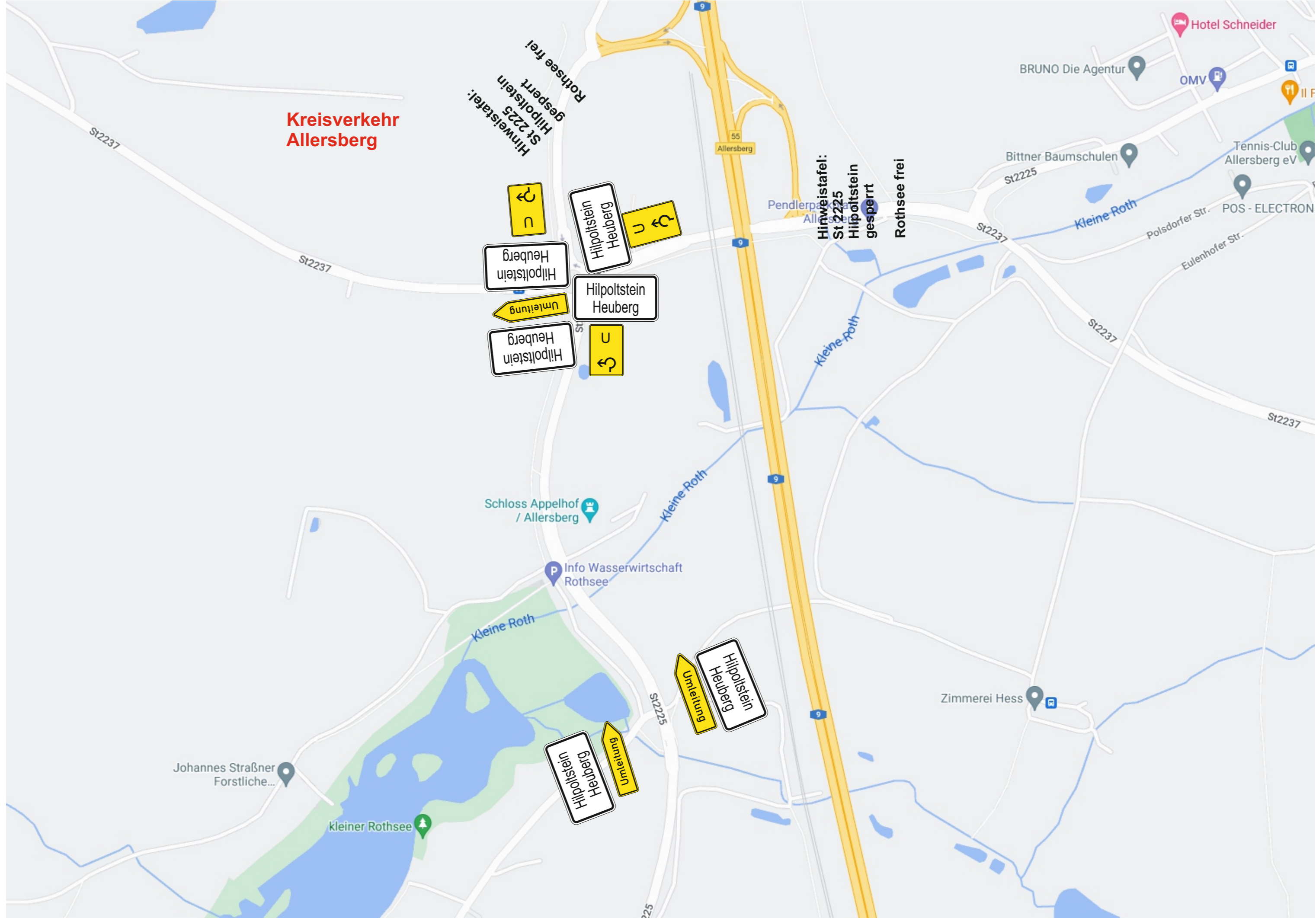
Vor- / Wegweiser am Kreisverkehr Allersberg und Abzweigung Eulenhof abdecken
