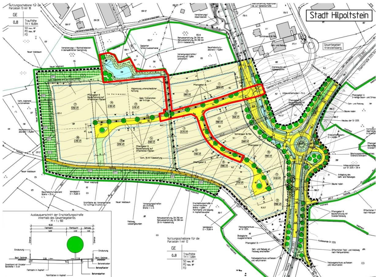
Abbildung 1: Ursprünglicher Bebauungsplan Nr. 8-3 Gewerbegebiet „Kränzleinsberg – Erweiterung“; die bisher erstellten Erschließungsanlagen („Bauabschnitt 1“) sind rot umrandet
